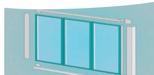
Aufbau Seitenwandsystem Flexowall
